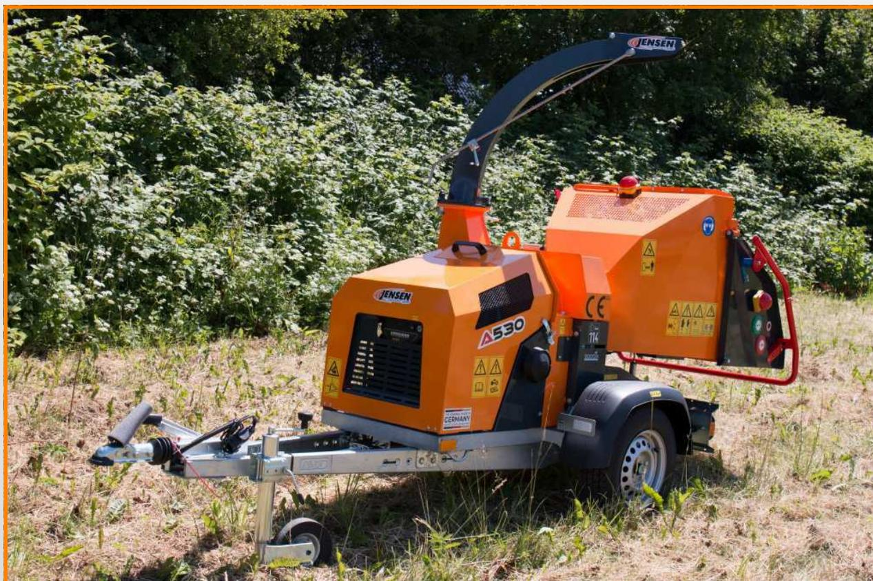
La biotrituradora más compacta, equipada con un motor a gasolina de inyección electrónica que cumple con todas las normativas de emisiones.
